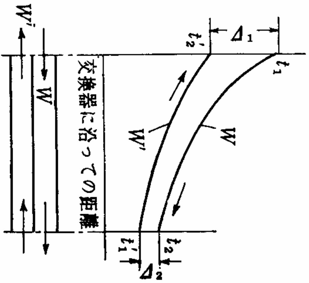
第2図 向流形熱交換器
